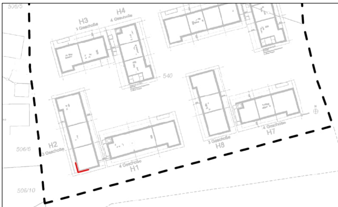
Abbildung 9: Lageplan mit Kennzeichnung der Fassadenbereiche, an denen Schallschutzmaßnahmen erforderlich sind
